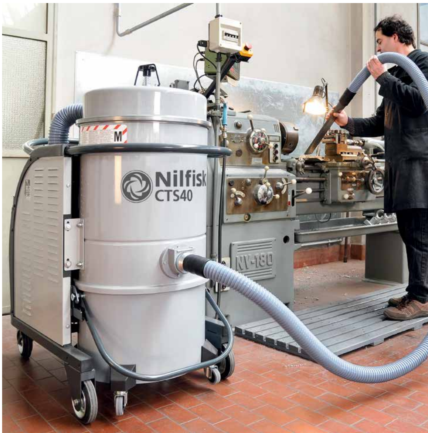
Nettoyage des copeaux dans une machine-outil
